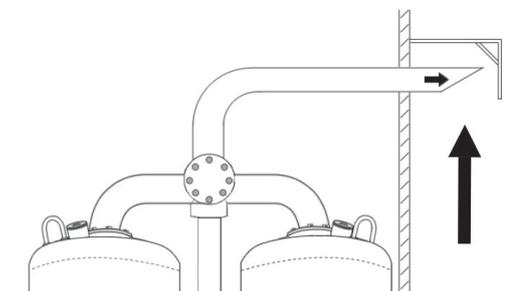
**Wetterschutz bei seitlicher Verlegung der Leitung**
